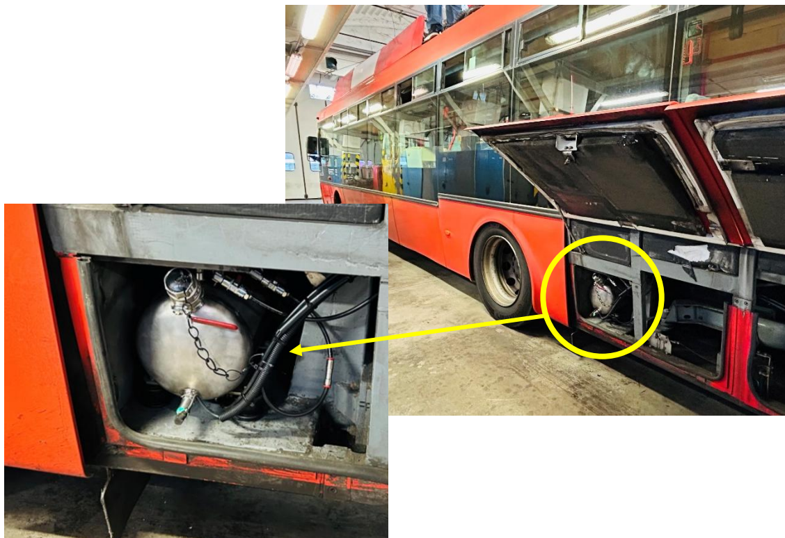
Obrázek 2 Umístění nádrže na podvozku
